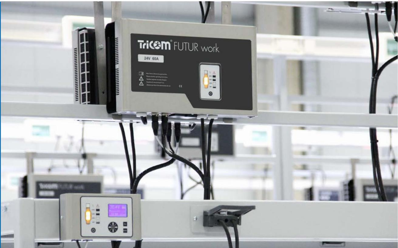
Hochintegrierte Schaltungstechnik zeichnet die Ladegeräte für Antriebsbatterien der Baureihe TriCOM FUTUR aus. Die Ladegeräte arbeiten mit getakteten Leistungshalbleitern. Anwenderfreundliche, kompakte und stabile Gehäuse sorgen für einen störungsfreien Betrieb und erleichtern die Bedienung.
